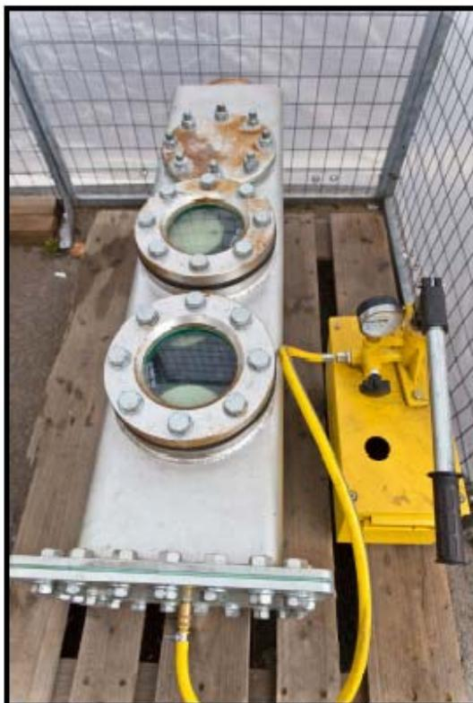
Ein zweiter Test wurde durchgeführt um das Verhalten des Kettenkörpers unter Druck zu testen. Dies wurde gemacht um den Druck zu simulieren, dem die Ketten in der Tiefsee ausgesetzt sind. Es galt mindestens eine Wassertiefe von 80m zu erreichen. Für diesen Test wurde ein Teil der Energieführungskette in einen dichten Behälter mit Salzwasser gefüllt. Das Ergebnis des Tests ist, dass sogar 10bar Druck ausgehalten werden.
